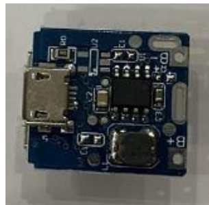
Hình 2. 11 Mạch sạc 1 cổng USB chuẩn- Pin Lithium[14]
