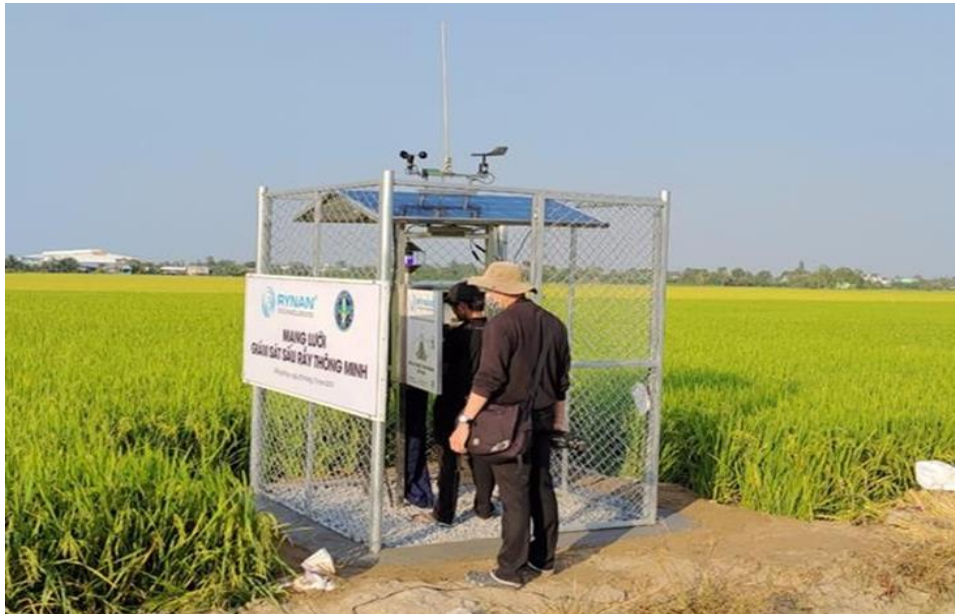
Hình 1.9 Hệ thống giám sát sâu rầy thông minh ở tỉnh Đồng Tháp nước ta
