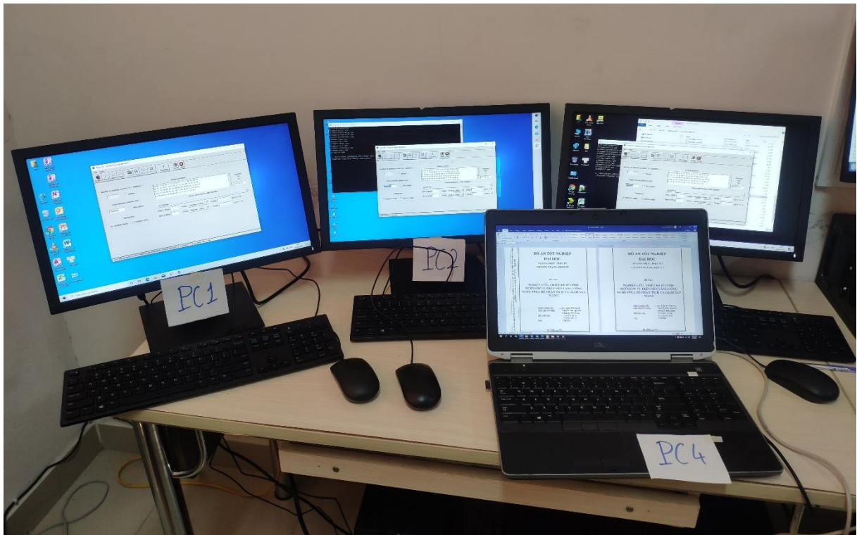
Hình 5.6 Thực hiện dùng 4 PC đẩy vào các gói tin liên tục để kiểm tra hệ thống.
