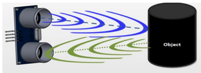
Hình 2.16: Hoạt động của cảm biến siêu âm
