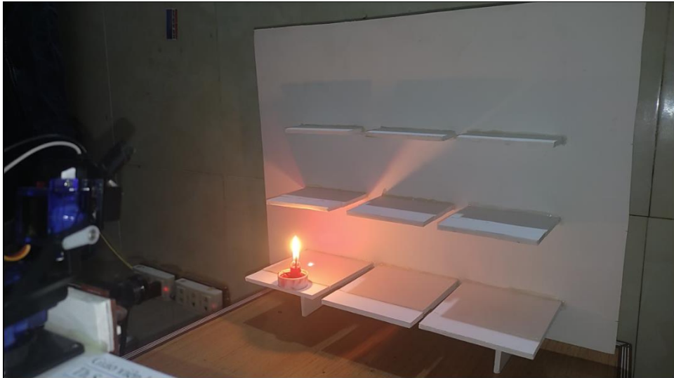
Hình 4-23: Khi mô hình phát hiện lửa ở vị trí số bảy.
