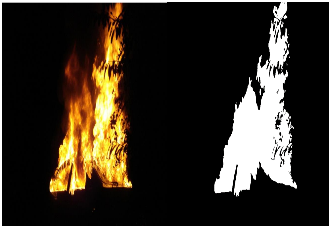
Hình 3-12: Ảnh cháy bình thường và ảnh cháy nhị phân.
