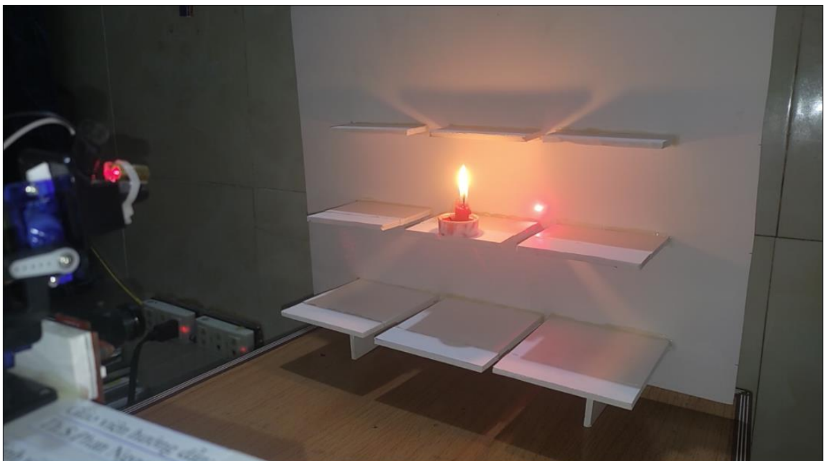
Hình 4-24: Khi mô hình phát hiện lửa ở vị trí số năm.
