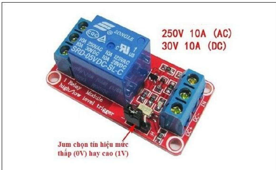
Hình 2-18: Module 1 Relay 5VDC.
